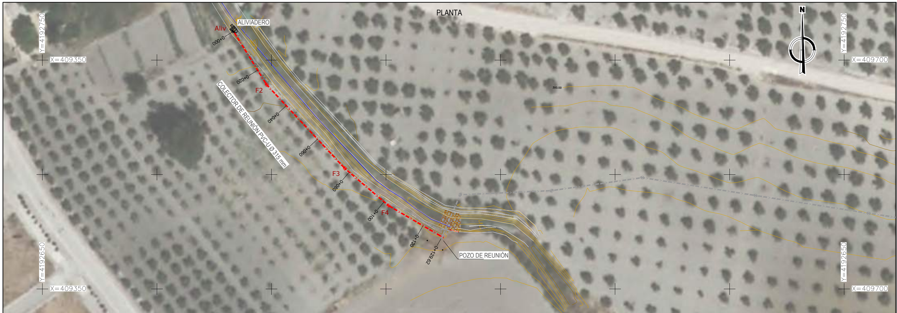
Colector de reunión PVC-U Ø315mm
